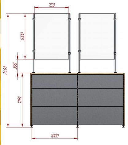
Зазор высотой 300 мм, между рабочей поверхностью и нижней частью экрана создает удобство в работе персонала, исключая необходимость выходить за защитную зону экрана для передачи товаров.
