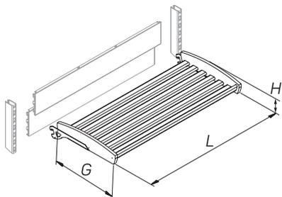
\* Боковины ЛДСП 16 мм, рейки из массива хвойных пород дерева, кронштейн 3-позиционный T-KW 03000280 в комплекте
